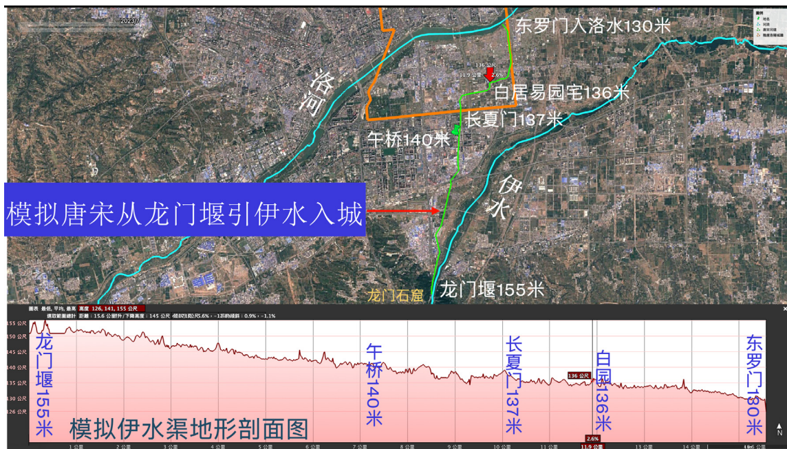
图 15 模拟唐宋时代自龙门堰引水，经午桥正北入城，经履道里西墙，出罗门合洛的工程示意图
